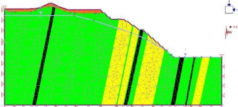
Gambar 5. Contoh Ilustrasi Model Sistem Statika Lereng (FEM)
